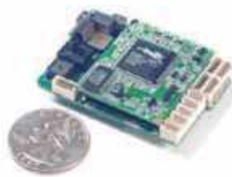
Fig. 3. Procerus Kestrel Autopilot (Beard et al., 2005).
