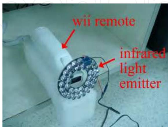
Fig. 6. Simple IR emitter
