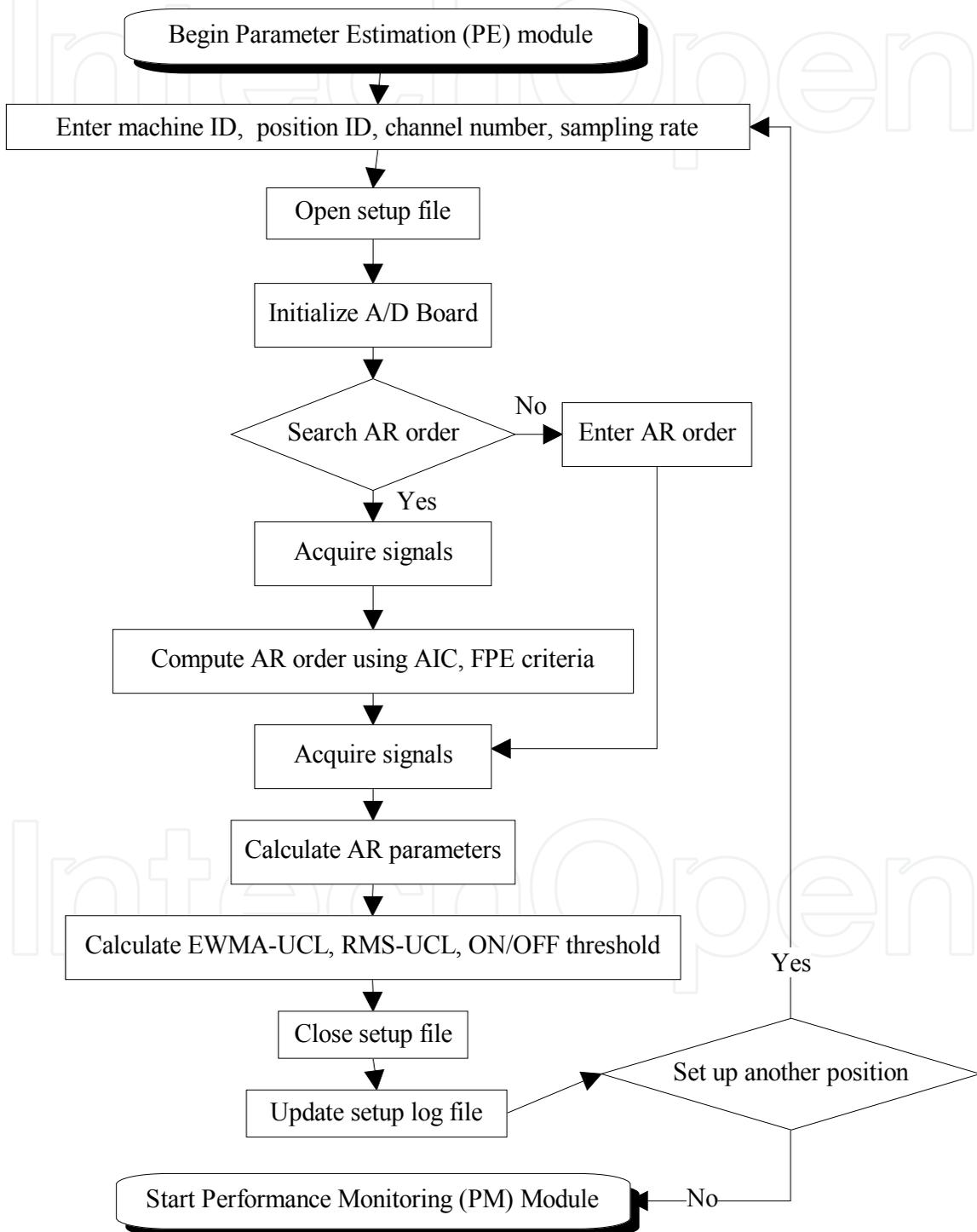
Fig. 2. Flowchart of parameter estimation (PE) module
