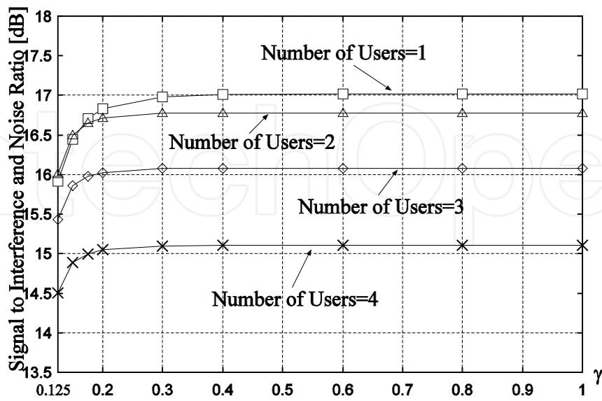
Fig. 16. SINR vs.  $\gamma$  ( $K=8$ ,  $SNR_{max}=10\text{dB}$ )
