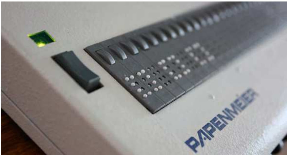
Fig. 10. Papenmeier BRAILLEX EL 40s Refreshable Braille Display
