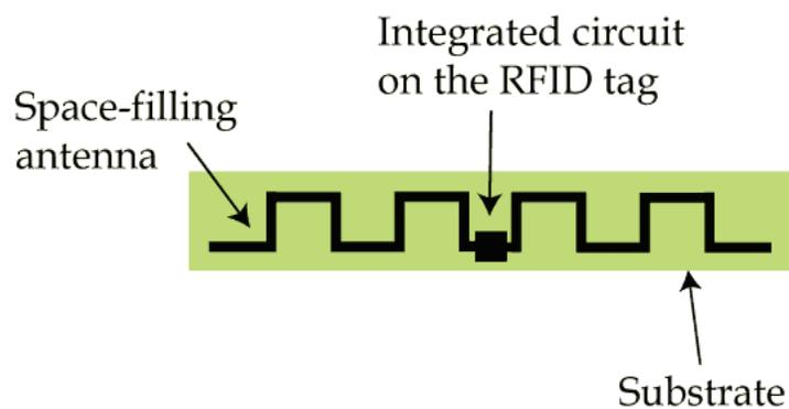
Fig. 2. A Passive RFID tag.
