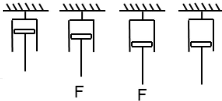
Fig. 2B. Viscous Element.
