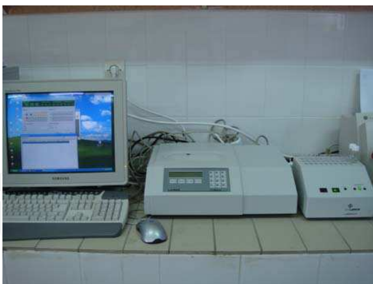
Fig. 4. Dr. Lange LUMISTox 300 Luminometer
