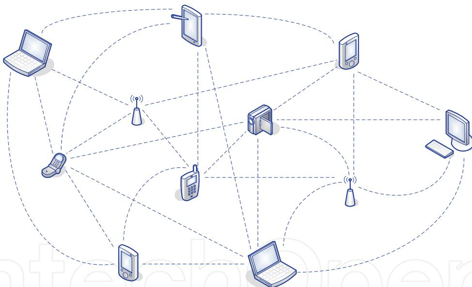
Fig. 1. A Mobile Ad-hoc Network (MANET)
